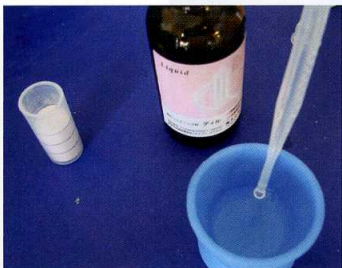
図6 液は粉末3目盛りに対してスポイトで2.5目盛り分をラバーカップに入れる。
