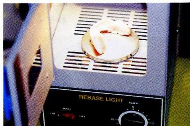
図29 これは亀水社製の光照射器である。現在市販されている他機種はいずれも二桁万円以上の高額なものが多いが、本品は一桁万円の手頃な値段であって、臨床家助けの品である。なお、義歯臨床の中で外注経費の要らない部門といえば、リライニングである。そして、局部床のリライニングには光重合タイプのリライニング材が必要である。このFdr-PERIに限らず多くの光重合タイプが今後増加するのは必至であるので、光照射器の設置をお勧めする。
