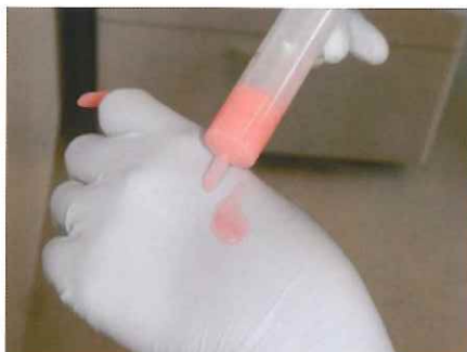
図7 シリンジ先端部(未混和部)の除去.
